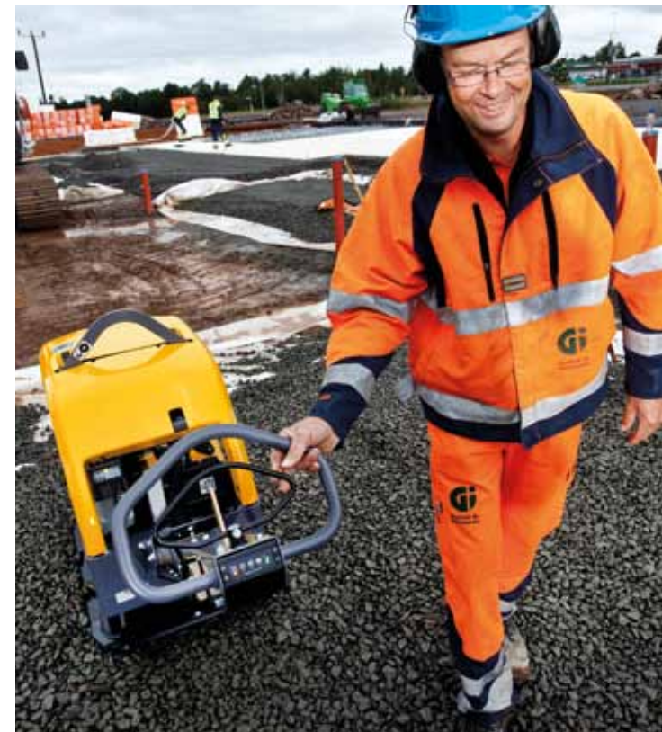
Der gut erreichbare Hebel für schnellen hydraulischen Fahrtrichtungswechsel.
